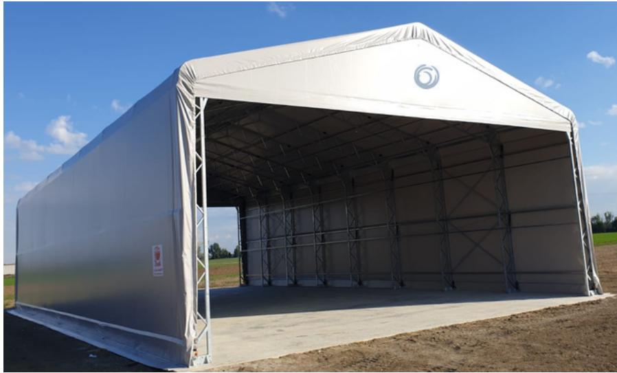
Tunnel autoportante a copertura totale a doppia falda con colonne verticali le cui piantane dovranno essere ancorate stabilmente tramite piastra con quattro picchetti per gamba nel caso di terreno o, nel caso di cemento, piastra completa di fissaggi meccanici e chimici.
